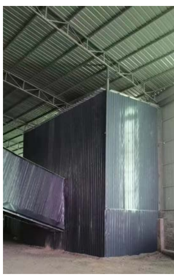
锤式破碎机废气收集措施
