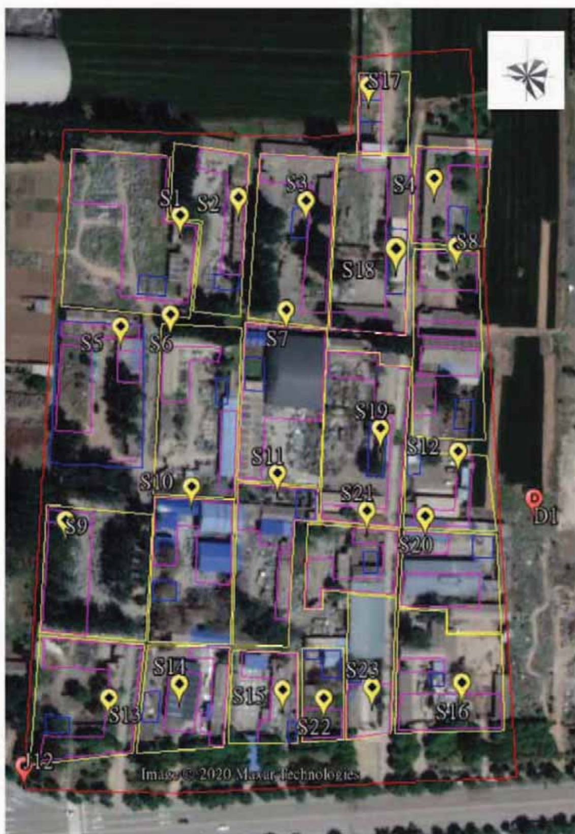
图 4-2 地块内原有企业内部生产车间、沉淀池分布与土壤监测点位设置对应情况示意图
